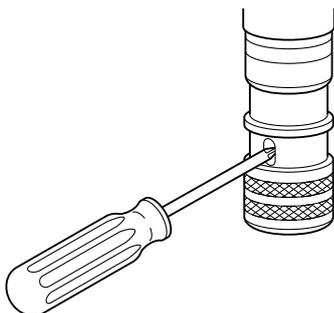
Das Drehmoment der Schrauber ist einfach einzustellen. Dazu muss nur die Abdeckhülse nach vorn geschoben werden, so dass der Verstellring sichtbar wird. Dieser hat an einer Stelle eine Einkerbung, in die ein Kreuzschlitz-Schraubendreher passt. Dreht man damit den Verstellring im Uhrzeigersinn, erhöht sich das Drehmoment, sinngemäß verringert sich das Drehmoment im Gegenuhrzeigersinn. Das Drehmoment lässt sich auf einer Skala zwischen den Werten 1 (min.) und 3 (max.) verstellen.
