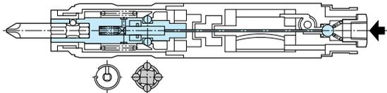
Vor der Verschraubung sind alle Teile der Kupplung in Ausgangsstellung. Der Lufteinlass am Schrauber ist verschlossen.
