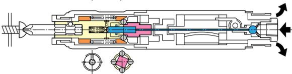
Während der Verschraubung öffnet der Druck auf den Schrauberbit den Lufteinlass (Automatikstart oder Schubstart). Der Schraubvorgang wird durchgeführt.
