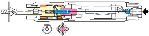
Bei der Abschaltung werden Kugeln in der Kupplung nach außen gedrückt, welche durch die Kupplungsfeder gehalten werden. Sobald die Federkraft überwunden ist, kann sich der Mitnehmer verdrehen und somit den Lufteinlass wieder schließen. Der Schrauber bekommt keine Luftzufuhr und schaltet ab.
