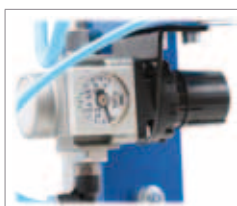
Druckregler zum einstellen der Balance (Gewicht)
