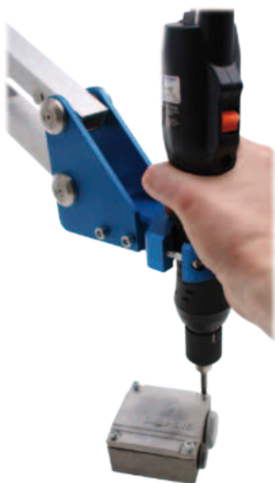
Axiallagerung der Hohltraversen (gewährleistet spielfreiheit)
