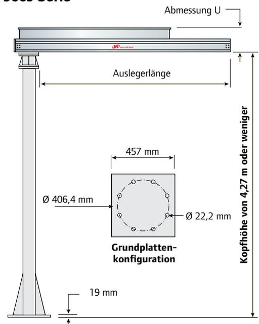
Standardstützen 152 mm x 152 mm x 6 mm, konzipiert für eine Kopfhöhe von 4,27 m oder weniger.
