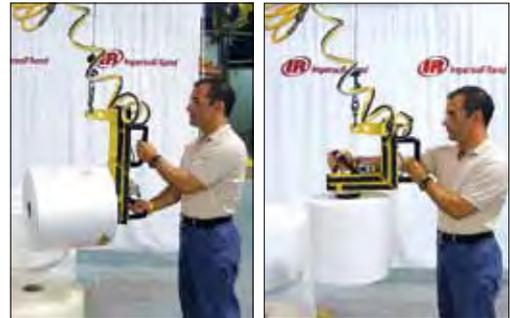
Mühelose Drehung von horizontal zu vertikal
