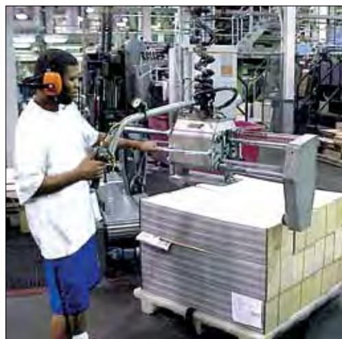
Einzelzylinder, Griffsteuerung mit Drehgelenk oben
