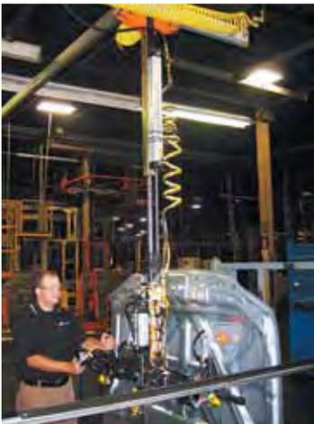
Drehmomentrohr mit integriertem Vakuum-Handhabungssystem
