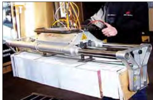
Doppelpylinder, Griffsteuerung mit Drehgelenk oben
