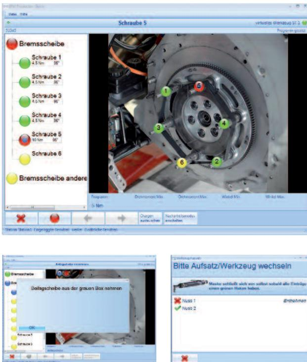
IPM-PG ist eine umfangreiche Lösung für die Werkerführung in einem Prozess. IPM-PG visualisiert Schraubstellen und zeigt IO und NIO Verschraubungen deutlich an. Gleichzeitig lassen sich in IPM-PG die verschiedensten Arbeitsanweisungen hinterlegen, die für den Montageprozess wichtig sind. Dazu gehören auch Anweisungen, welche Nuss oder welches Bauteil für den nächsten Prozessschritt genommen werden soll.
