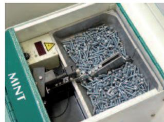
Das Modell CM-40 baut kompakter als das CM-30 und hat ein etwas größeres Füllvolumen. Die Schrauben werden hier in der Vereinzelungsschiene durch Vibration nach vorn zur Vereinzelung geführt.
