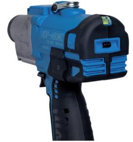
Optional Kabelanschluss von oben, Code "TL". LED zur Anzeige von IO/NIO gut sichtbar für den Anwender
