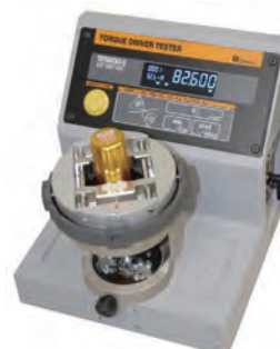
Abbildung einer Kalibrierung der Drehmomentschraubendreher links und FTD rechts mit TDT3-G
