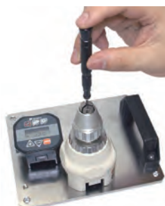
AMRD Drehmomentüberwachung mit ATGE-G und Messstand.
