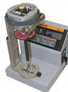
Abbildung einer Kalibrierung der Drehmomentschraubendreher links und FTD rechts mit TDT3-G
