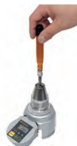
BMRD Drehmomentüberprüfung mit BTGE-G und Messstand.
